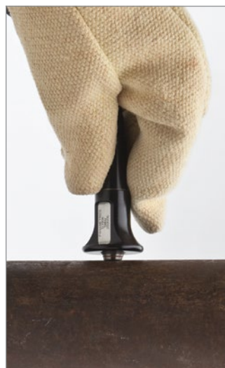
高温パイプ用D790-SM探触子
