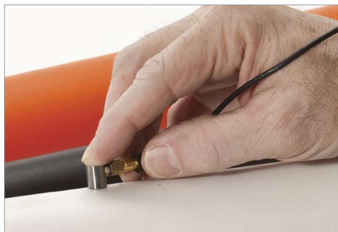
プラスチック、金属、ゴム、ガラス、セラミック、および複合材の肉厚を測定
