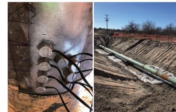
掘削時の検査またはインテリジェントピグ検査で発見されたピットの監視
