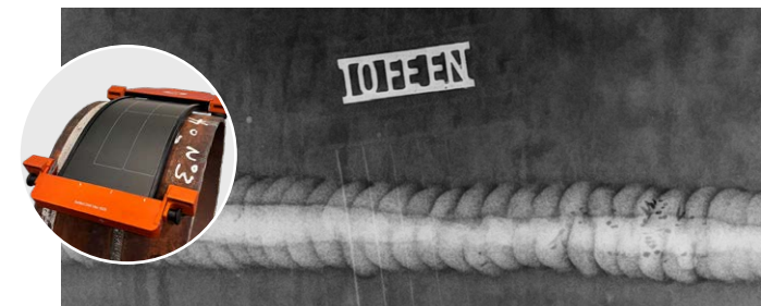
DXR Flex:16インチSCH30 - DWSI, Ir192 ISO 17636-2 | クラスB達成 | フラッシュ駆動!
