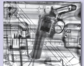
銃器と懐中電灯が 4 人乗りトラックの反対側のドアに隠されていた。両写真とも 0.031Gy / 分 250pps にて撮像。手前のドアまで 3 メートル、80 秒間デジタルラジオグラフィイー (DR)
