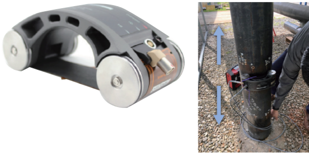
探傷風景—矢印は超音波伝搬方向
