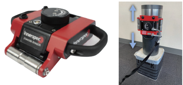
探傷風景—矢印は超音波伝搬方向
