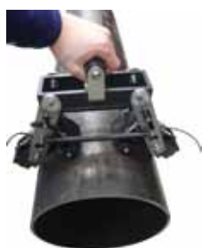
配管探傷用治具
