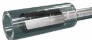
パイプ内面からの探傷例
