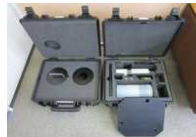
上：専用キャリングケース 下：計測用マリネリ容器
