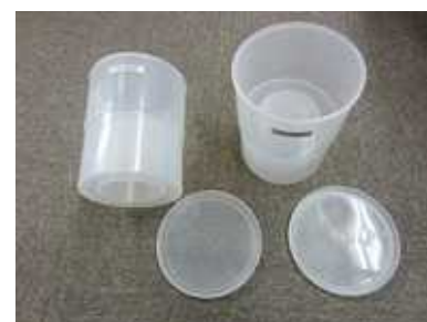
上：専用キャリングケース 下：計測用マリネリ容器
